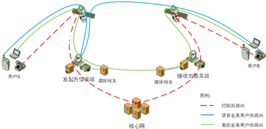
图 2 跨信关站卫星互联网用户业务机制
