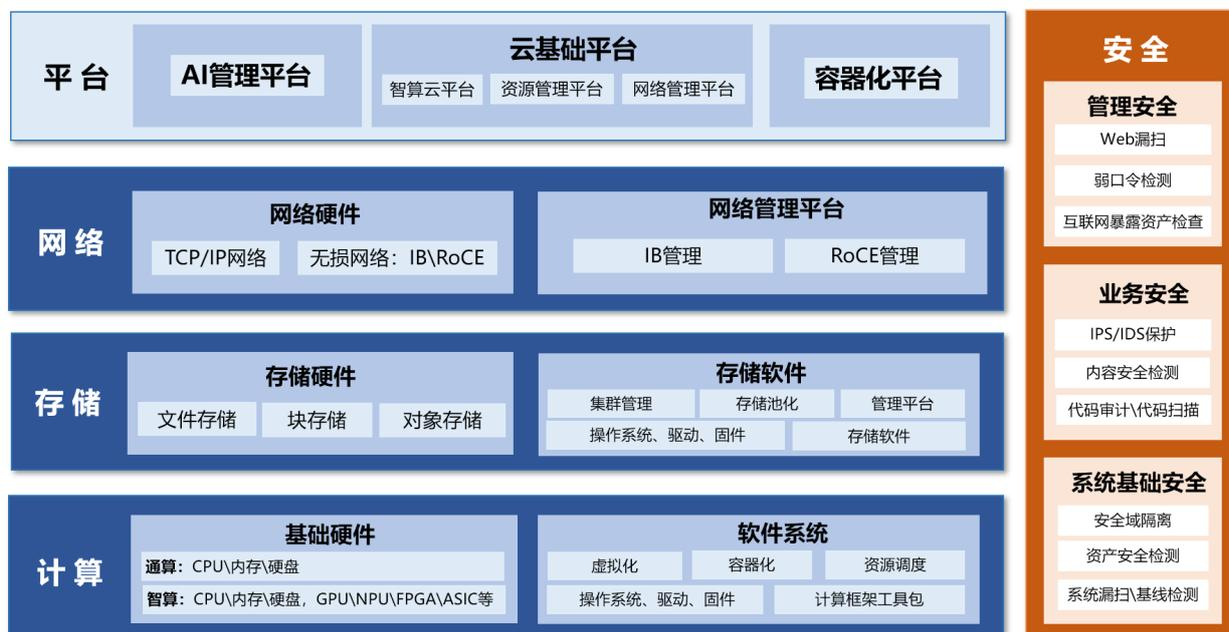
图 5.1 智算系统集成架构图
