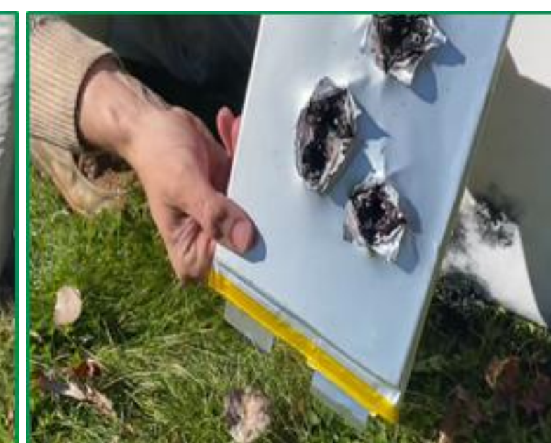
枪击测试后，电芯仍可放电
