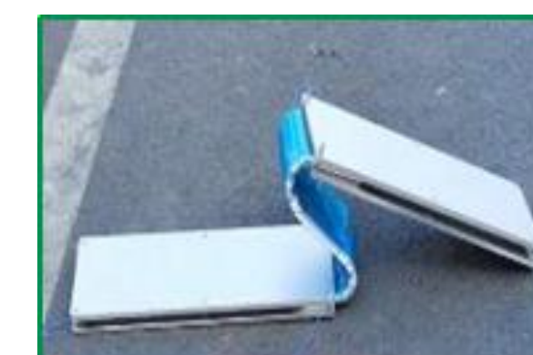
折弯形变，电压温度正常
