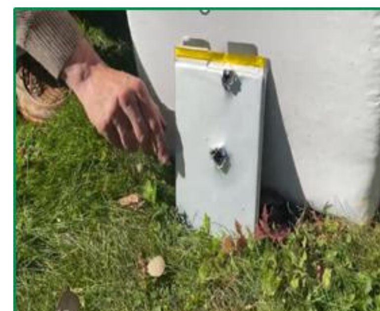
枪击测试后，电芯仍可放电
