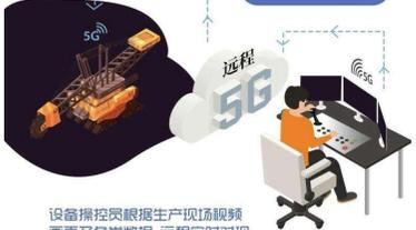
设备操控员根据生产现场视频画面及各类数据，远程实时对现场工业设备进行精准操控
