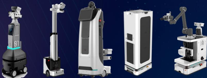
5. 升压站变电站轮式巡检机器人
