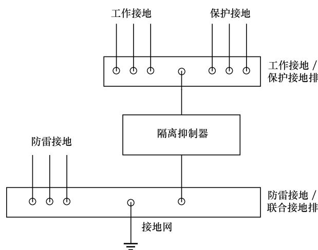
图 3 隔离式接地装置组成结构示意
