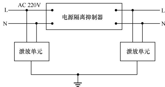
图 2 单相交流用隔离式电源保护装置组成结构
