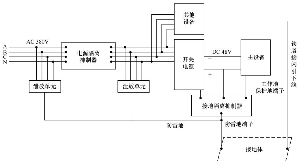
图 1 隔离式雷电防护系统结构示意
