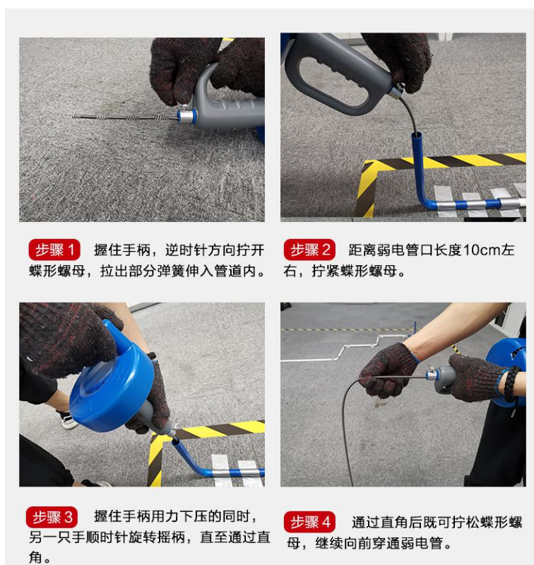
图 B.2 橄榄头弹簧穿管器穿管操作示意图
