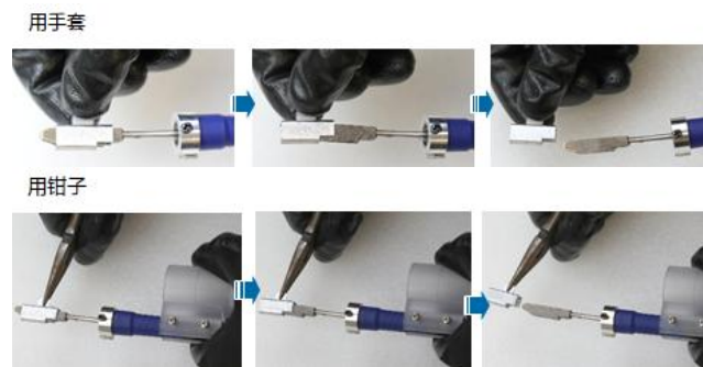
图 C.1 铝合金部件拆卸示意图
