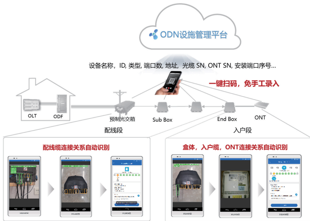
图 6-2 图像识别建立 ODN 连接关系
