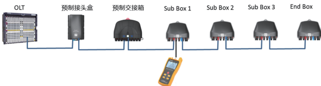
❗ 图 5-14 预连接 ODN 验收测试示意图 ❗
