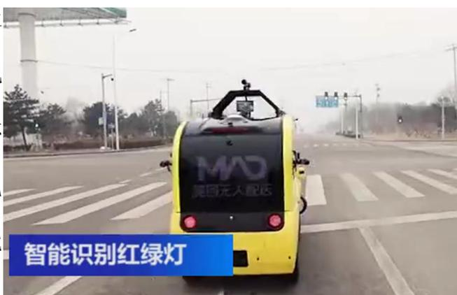
给无人配送车，无人车在美团买菜站点取货，自动行驶到目的地社区的无接触配送点，与取货人交接打开餐箱取出物品，全流程隔绝人与人的接触。无人驾驶每秒需消耗 0.75GB 的数据流量，需要超高速率、超低时延的传输才能满足，而 5G 技术恰好可以达到这个要求。
